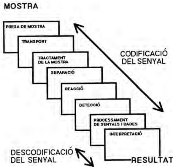
FIGURA 2. Principals etapes dels procediments experimentals de dur a terme el procés analític. La creació experimental d'informació analítica és efectuada per mitjà del procés analític (veg. la fig. 1).
